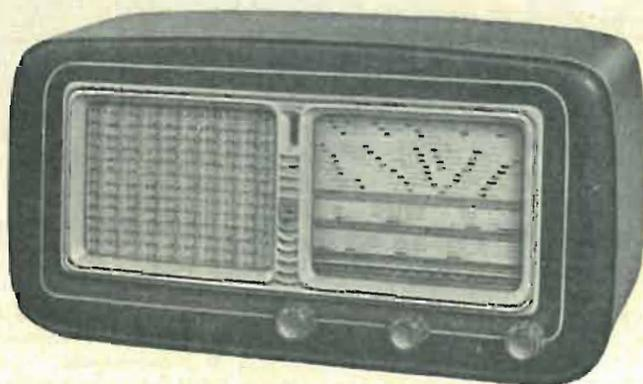
**BI. 252 A.** « SERIE ANIE » (Stesse facilitazioni del BI 250 A). Supereterodina a 5 valvole « Rimlock - Noval » più indicatore di sintonia; onde medie e corte; antenna a filo incorporata; alimentazione in c. a. su tutte le tensioni.
