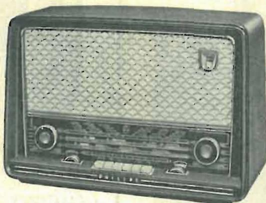
**BI. 550 A.** con MODULAZIONE DI FREQUENZA 7 valvole « Rimlock - Noval » più occhio magico; due gamme di onde corte; onde medie e « modulazione di frequenza »; comandi a tastiera; doppio regolatore di tono; due indici separati per AM e FM; antenna incorporata; presa per fono e altoparlante supplementare.
