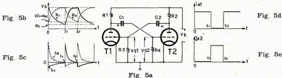
1) la corrente di scarica del condensatore C1 fluisce nel resistore R4 per cui si determina ai capi di esso una tensione negativa di polarizzazione che annulla la corrente anodica del tubo T2 (fig. 5 e);
